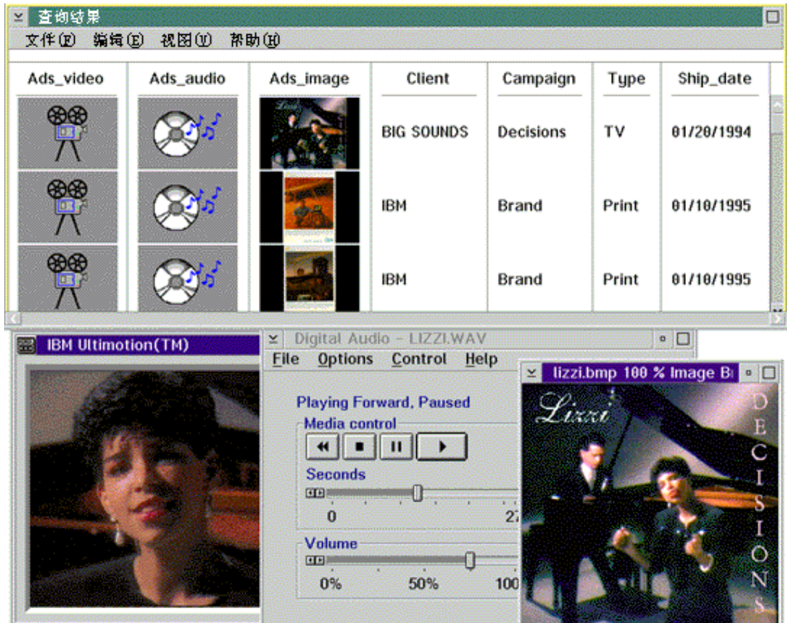
图 1. 多媒体数据库表. 该表包含图象、音频和视频数据, 以及传统数据类型。显示视频、音频和图象。
