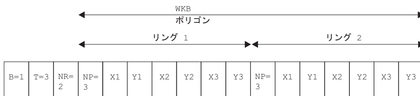
図 57. NDR フォーマットの形状表記：2 つの線形を持つ (NR=2)、タイプがポリゴン (T=3) の (B=1)。ここで各リングは 3 つのポイントを持つ (NP=3)。
