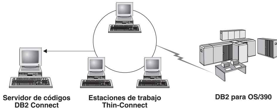
Figura 3. Topología de cliente Thin habitual que utiliza DB2 Connect Personal Edition
