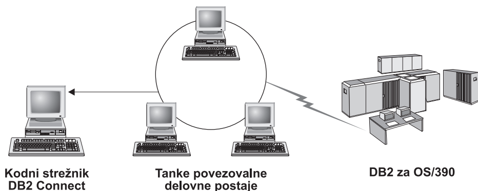
Slika 2. Značilna topologija tankega odjemalca, ki uporablja DB2 Connect Personal Edition
