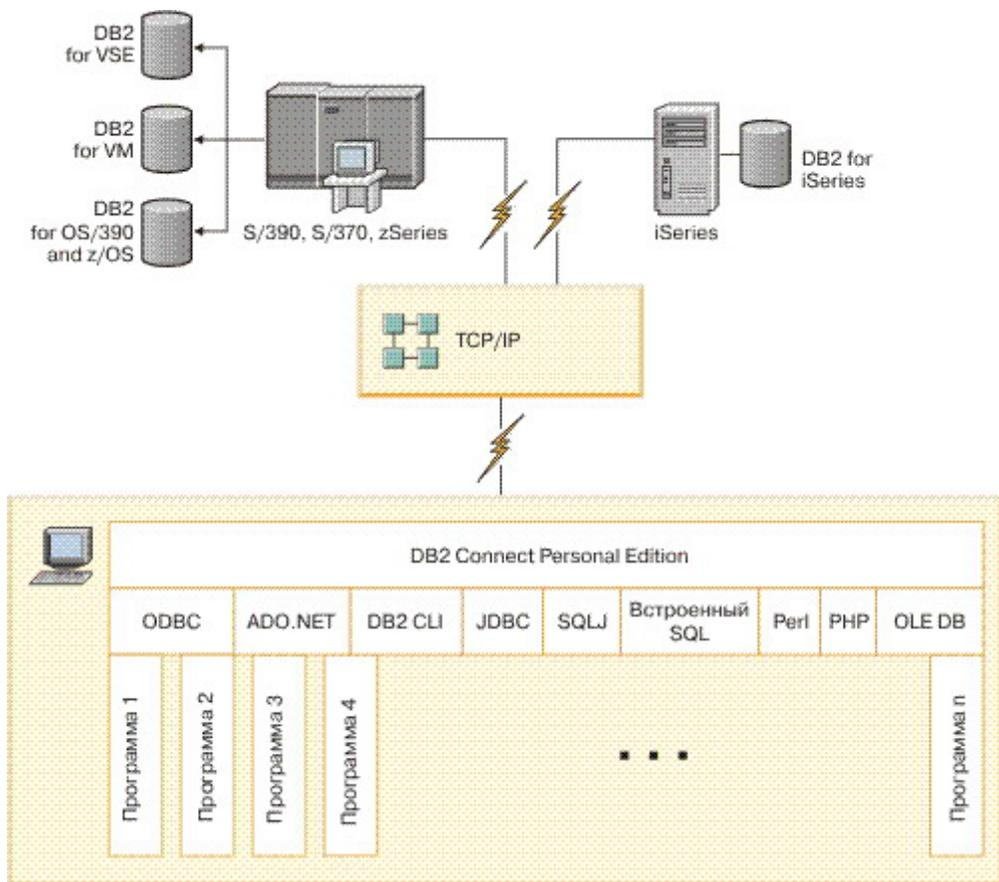
Рисунок 3. Прямое соединение между DB2 Connect и сервером баз данных хоста или System i
