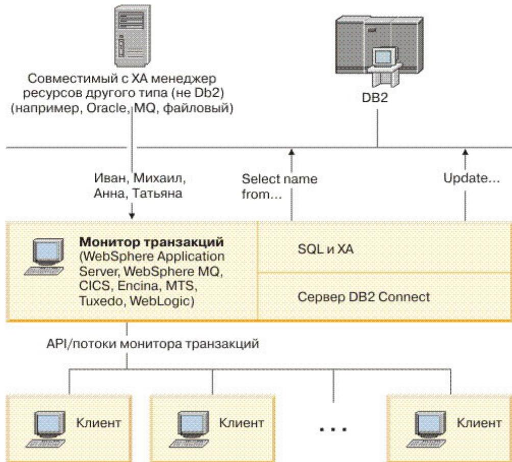
Рисунок 7. Поддержка DB2 Connect для мониторов транзакций
