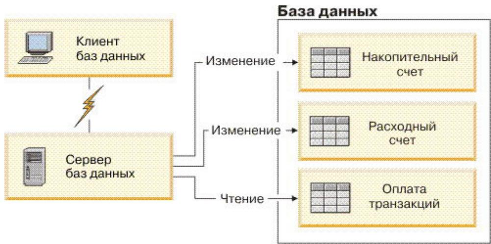
Рисунок 2. Использование в транзакции одной базы данных
