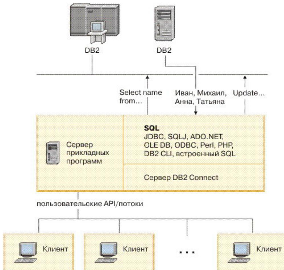
Рисунок 6. Поддержка DB2 Connect для серверов прикладных программ
