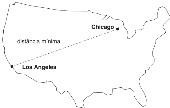
Figura 57. Distância mínima entre duas cidades. ST_Distance pode ter as coordenadas para os locais de Los Angeles e Chicago como entrada e retornar um valor indicando a distância mínima entre esses locais.
