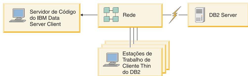
Figura 1. Uma Típica Topologia do Cliente Thin Utilizando o IBM Data Server Client
