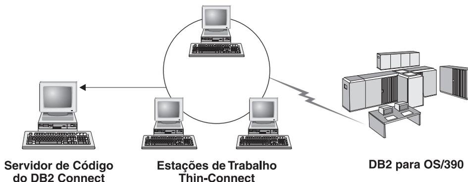
Figura 2. Uma Típica Topologia do Cliente Thin Utilizando o DB2 Connect Personal Edition
