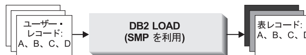
図 12. ロード操作中に、データベース・パーティションごとに実行されるプロセスの数を利用した場合にソース・データのレコード順序は保持される
