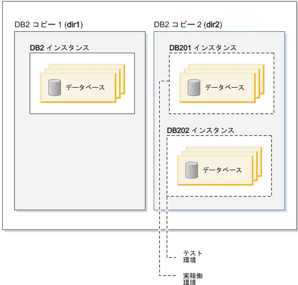
バージョン 8 およびバージョン 9 以降のコピーは、同じコンピューター上に共存させることができます。ただし、バージョン 8 がデフォルトの DB2 および IBM データベース・クライアント・インターフェース・コピーでなければなりません。インストール中に、デフォルトの DB2 コピーまたはデフォルトの IBM データベース・クライアント・インターフェース・コピーをバージョン 8 のコピーからバージョン 9 以降のコピーに変更することはできません。また、最初にバージョン 8 のコピーをマイグレーションまたはアンインストールしない限り、デフォルト・コピーを切り替えるためのコマンド `db2swtch` を後から実行することもできません。`db2swtch` コマンドを、バージョン 8 がシステム上に存在しているときに実行する場合、バージョン 8 がシステム上に見つかったためにデフォルトのコピーを変更できないことを示すエラー・メッセージを受け取ります。
