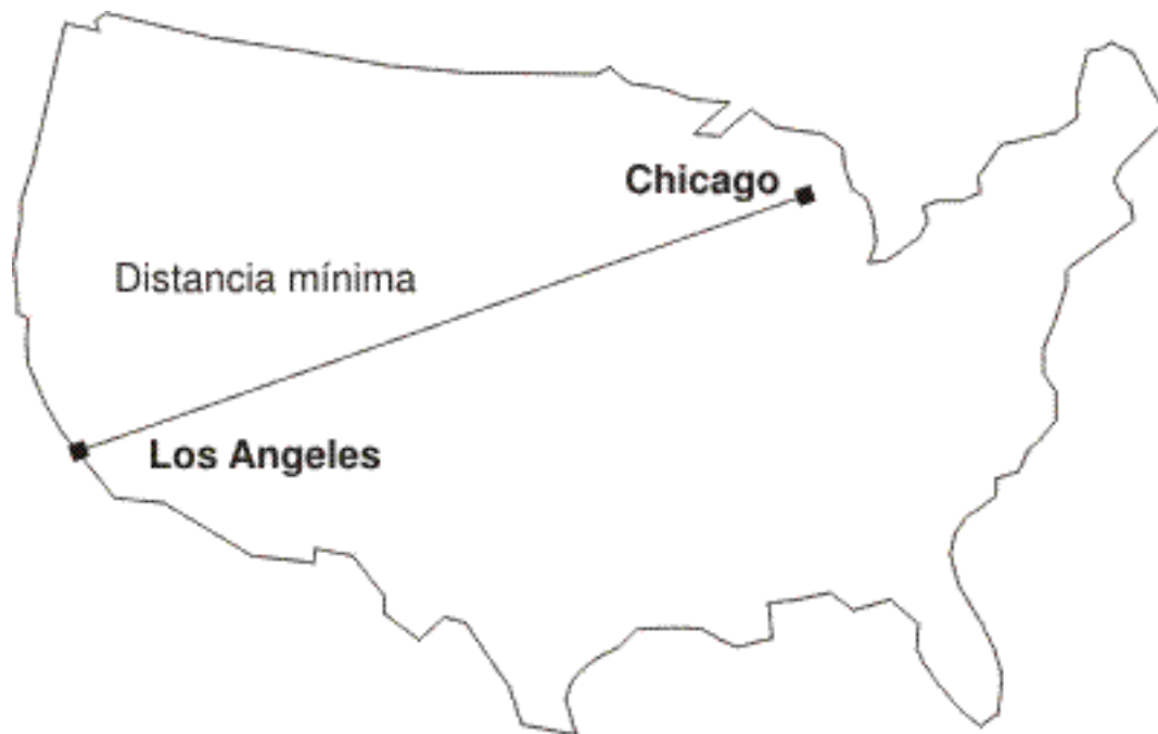
Figura 57. Distancia mínima entre dos ciudades. ST_Distance puede utilizar como entrada las coordenadas de las ciudades de Los Angeles y Chicago y obtener el valor correspondiente a la distancia mínima entre estas ciudades.
