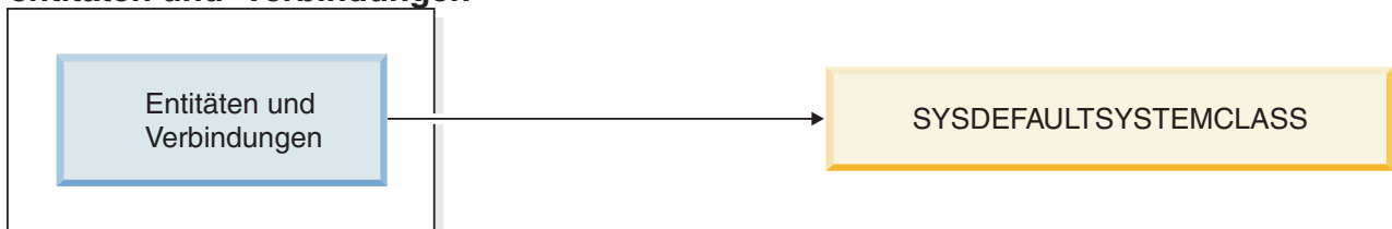
Abbildung 11. Zuordnung von Datenbankverbindungen zu einer Servicesuperklasse
