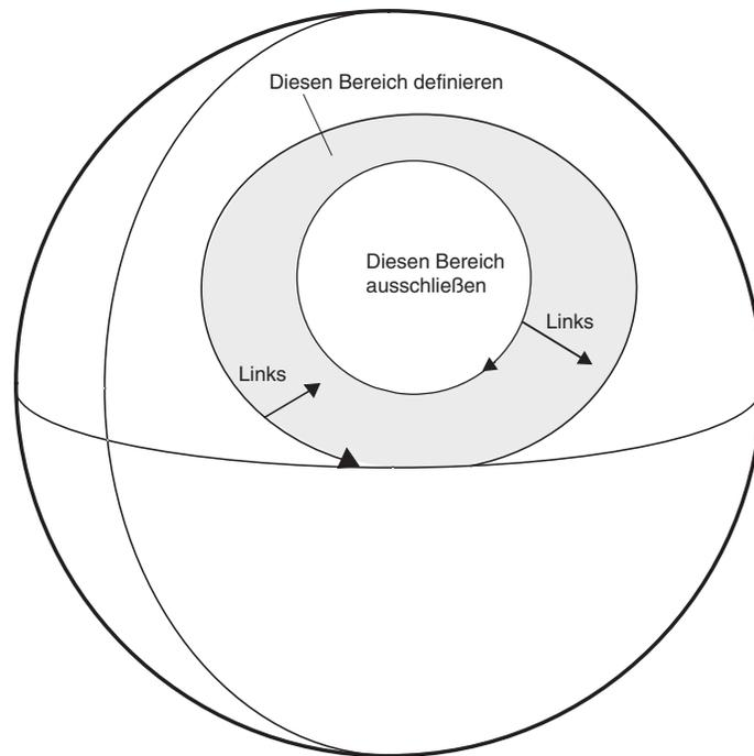
Abbildung 20. Definieren eines Bereichs mit mehreren Ringen
