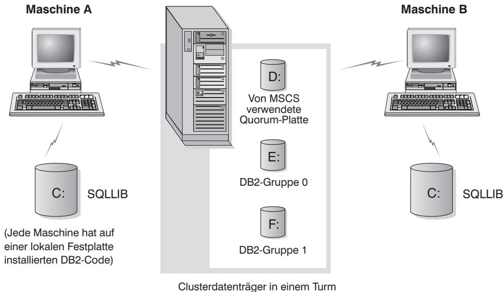
Abbildung 3. Beispiel für eine MSCS-Konfiguration
