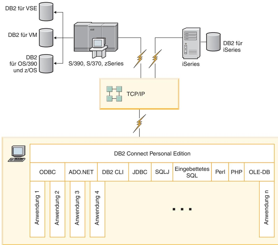
Abbildung 4. Direktverbindung zwischen DB2 Connect und einem Host- oder System i-Datenbankserver
