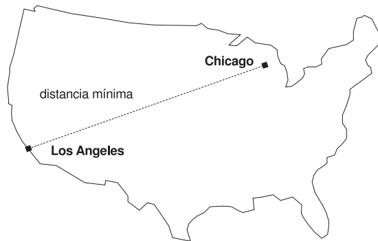
Figura 20. Distancia mínima entre dos ciudades. ST_Distance puede tomar las coordenadas correspondientes a las ciudades de Los Angeles y Chicago como entrada y devolver un valor que indique la distancia mínima entre estas ubicaciones.
