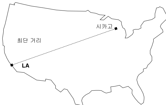
그림 20. 두 도시 사이의 최단 거리. ST_Distance는 LA와 시카고의 위치 좌표를 입력으로 취하고 이 위치들 사이의 최단 거리를 나타내는 값을 리턴할 수 있습니다.
