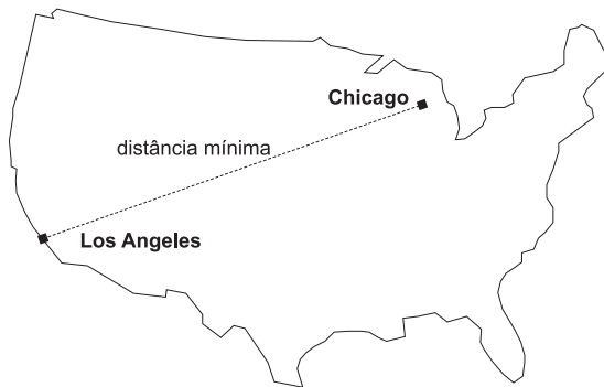
Figura 20. Distância mínima entre duas cidades. ST_Distance pode tomar as coordenadas para as cidades de Los Angeles e Chicago como entrada e retornar um valor indicando a distância mínima entre estes locais.
