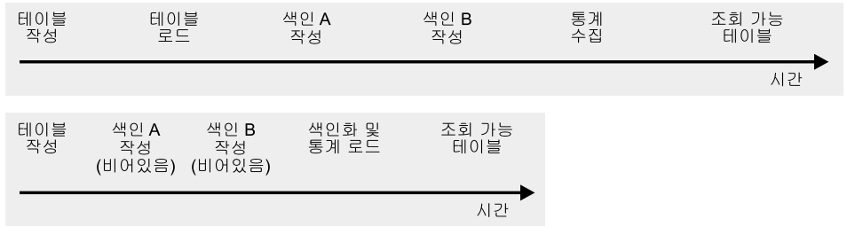
그림 5. 동시적인 색인화 및 통계 수집을 통해 로드 성능 향상. 일반적으로 테이블은 세 단계, 즉, 데이터 로드, 색인 빌드 및 통계 수집으로 빌드됩니다. 이 때문에 로드 조작, 색인 작성(각 테이블에 대해 여러 색인이 있을 수 있음) 및 통계 수집(테이블 데이터와 모든 색인에서 I/O를 일으키는) 중 다수의 데이터 I/O가 일어납니다. 훨씬 더 빠르게 수행하기 위한 다른 방법은 로드 유틸리티가 데이터를 한 번 통과하여 이들 작업을 모두 완료하는 것입니다.
