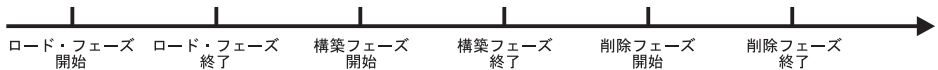
図1. ロード・プロセスの3つのフェーズ: ロード、構築、削除。関連する表スペースは、ロード・フェーズの始点から構築フェーズの終点まではロード保留状態、また構築フェーズの終点から削除フェーズの終点までは削除保留状態になります。
