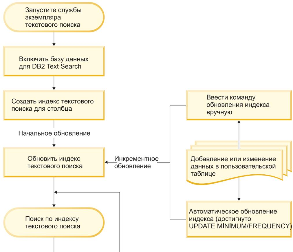
Рисунок 10. Конфигурирование индексов текстового поиска для поиска в одностолбчатом экземпляре при использовании интегрированного сервера Text Search
