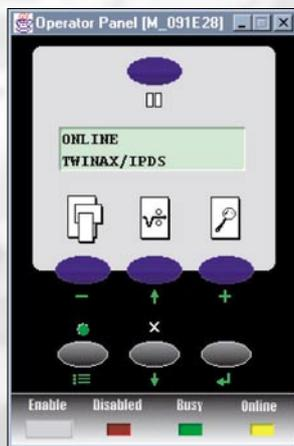
*Le panneau opérateur de l'imprimante est accessible à distance à partir de votre poste de travail et permet de modifier les paramètres ou les configurations.*
