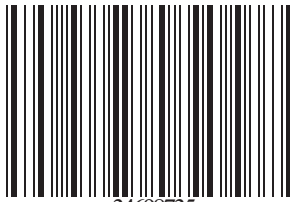
Codabar (encoding A34698735B)
