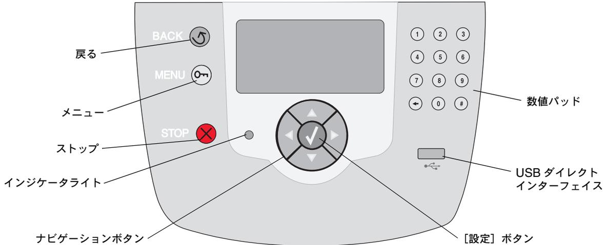
以下の表に、ボタンの機能と表示パネルでの配置を示します。
