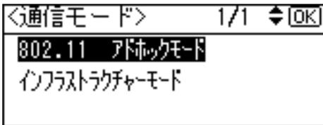
SSID の設定が必要ない環境で無線 LAN を使用する場合は、[アドホックモード] を選択します。
