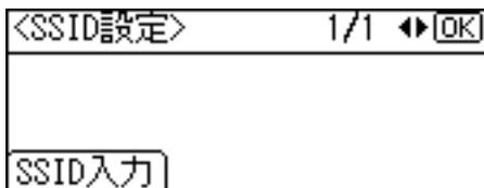
「SSID を入力してください。」のメッセージが表示されたら、[入力] の選択キーを押します。
