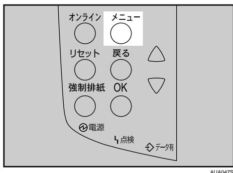
2 [▲] [▼] キーを押して、「ヒョウジケンゴ」を表示させ、[OK] キーを押します。
