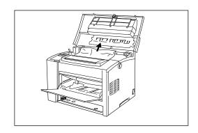
13 E P カートリッジの取っ手を持ち、E P カートリッジの両側にある突起をプリンターのプリンター内部の溝に合わせて、プリンター内部に挿入します。
