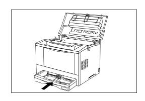
**16**上面カバーを閉じます。 上面カバー中央を押して確実に ロックして閉じます。
