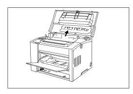
**10** E P カートリッジの取っ手を持ち、E P カートリッジの両側にある突起をプリンターのプリンター内部の溝に合わせて、プリンター内部に挿入します。
