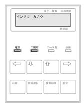
最後に、印刷可ランプが点灯し、液晶表示部に上のようなメッセージが表示され、データを受信できる状態(印刷可能状態)になります。
