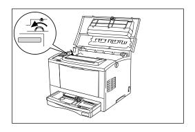
3 上面カバーを元に戻します。上 部カバーを上から押して、確実 にロックします。
