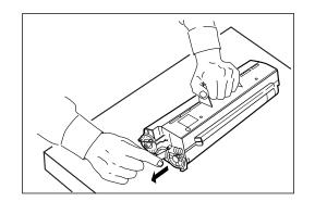
6 EPカートリッジの取っ手を持ち、EPカートリッジの両側にある突起をプリンターのプリンター内部の溝に合わせて、プリンター内部に挿入します。
