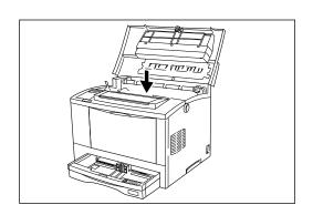
8 上面のカバーを元に戻します。 上部カバーを上から押して、確 実にロックします。
