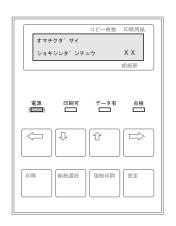
次に、電源ランプが点灯した 状態で液晶表示部に上のよう なメッセージが表示され初期 診断テストが始まります。
