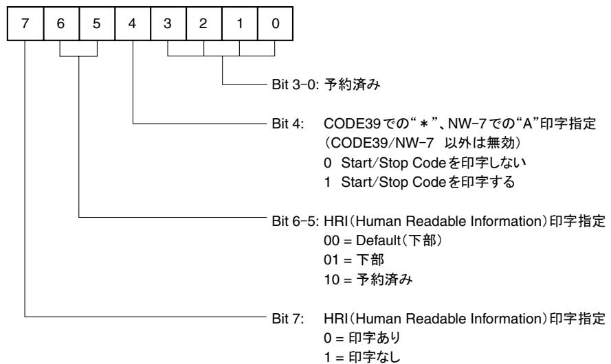
DATA (n1n2-5バイト) : バーコード・データを指定します。規格にて指定されている最大数を超える場合、すべてのデータを無視します。また、左右の印字領域を超えて印字するデータが送られた場合もすべてのデータが読み捨てられます。データが固定長のバーコード (JAN 短縮、JAN 標準) の場合、固定長を超えたデータを受信するとすべてデータが読み捨てられます。また、文字セットに関しても同様に下記掲載セット以外は全体が読み捨てられます。
