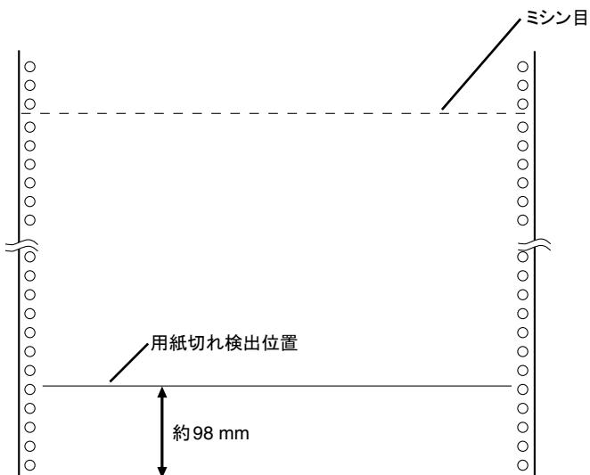
連続用紙が印刷中に用紙切れとなつた場合は、印刷業務を取り消し、新しい用紙をセットしてから印刷を再開してください。そのまま最終ページの印刷を印刷可能域下端まで印刷する場合は、用紙切れ状態（点検ランプが点灯し、「001 ヨウシ テンケン」が表示される）で印刷スイッチを押します。1行を印刷し再び用紙切れ状態となります。この操作を繰り返すと論理ページ長（ソフトウェアまたはプリンターの初期設定機能によって設定されたページ長）の最終行まで印刷できますが、以下の注意点を守ってください。
