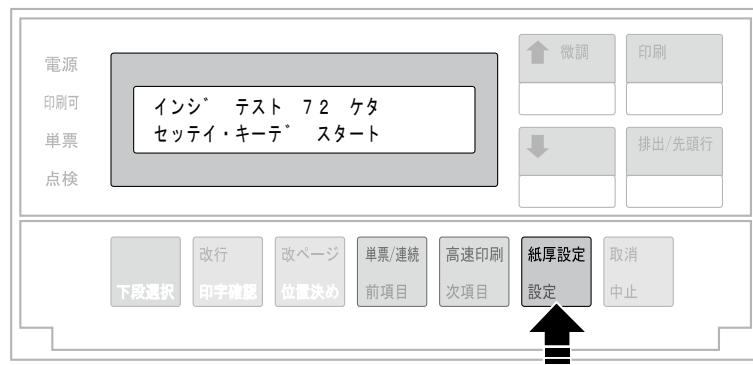
**4** 印刷スイッチを押すと、印刷可ランプが点灯し、次に示す1行72桁の指定された印字パターンを繰り返し印字します。
