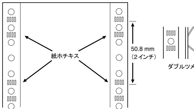
紙ホチキスによる用紙の固定は、ダブルツメにて(4ツメ)2インチ間隔で固定してください。用紙の種類によっては、用紙詰まりまたは印字ズレを起こすことがあります。必ず事前にテストをしてから使用してください。
