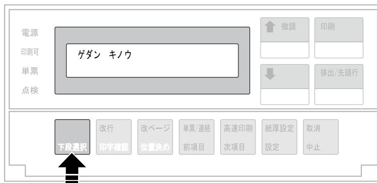
**2** 次項目スイッチを押して「1 インシ テスト」を選択し、設定スイッチを押します。
