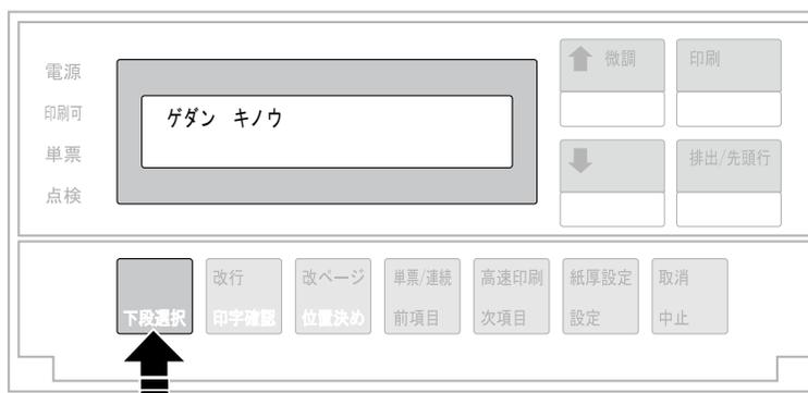
**6** 「ゲダン キノウ」と表示されていることを確認し(表示されていない場合には、下段選択スイッチを押します)、位置決めスイッチを押します。
