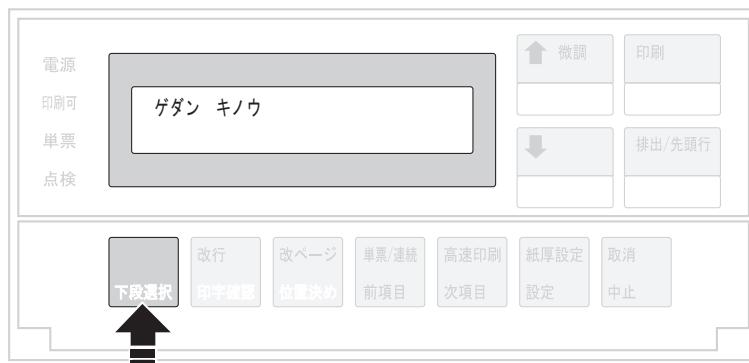
**2** 次項目あるいは前項目スイッチを押して、「2 ショキチ セッティ」を表示させ、設定スイッチを押します。
