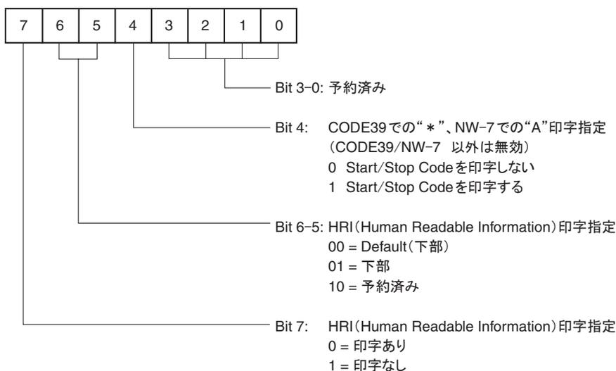
DATA (n1n2-5バイト) : バーコード・データを指定します。規格にて指定されている最大数を超える場合、すべてのデータを無視します。また、左右の印字領域を超えて印字するデータが送られた場合もすべてのデータが読み捨てられます。データが固定長のバーコード (JAN 短縮、JAN 標準) の場合、固定長を超えたデータを受信するとすべてデータが読み捨てられます。また、文字セットについても同様に下記掲載セット以外は全体が読み捨てられます。
