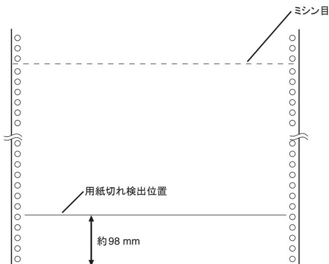
連続用紙が印刷中に用紙切れとなった場合は、印刷業務を取り消し、新しい用紙をセットしてから印刷を再開してください。そのまま最終ページの印刷を印刷可能域下端まで印刷する場合は、用紙切れ状態（点検ランプが点灯し、「001 ヨウシ テンケン」が表示される）で印刷スイッチを押します。1行を印刷し再び用紙切れ状態となります。この操作を繰り返すと論理ページ長（ソフトウェアまたはプリンターの初期設定機能によって設定されたページ長）の最終行まで印刷できますが、以下の注意点を守ってください。
