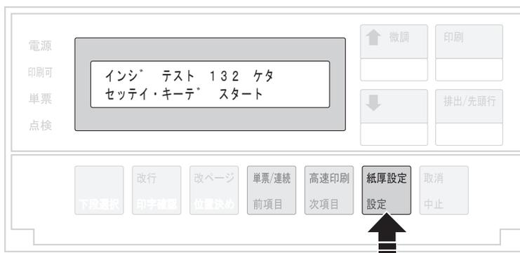
**4** 印刷スイッチを押すと、印刷可ランプが点灯し、1行132桁の指定された印字パターンを繰り返して印字します。
