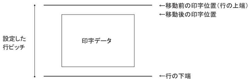
縦方向の印字位置の移動後は、同一行中で行ピッチの変更はできません。行の途中で設定された行ピッチは、次の行から有効になります。
