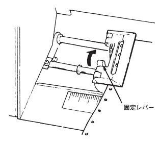
5 用紙に合わせて右のトラクターを移動し固定レバーを矢印の方向に倒してロックし てください。
