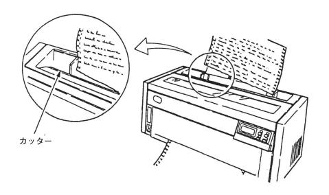
2 印刷不可状態(印刷可ランプが消えている)になっていることを確かめてから、操 作パネル・カバーを開け、単票/連続スイッチを押して単票モードにしてください。 連続用紙の先頭行位置がトラクターの位置まで逆送りされます。
