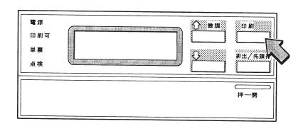
2 操作パネル・カバーを開け高速印刷スイッチを2秒以上押してください。用紙押さえ ローラーが開きます。このとき、「ゲダンキノウ」と表示されていたら下段選択ス イッチを押して「ゲダンキノウ」を解除してください。
