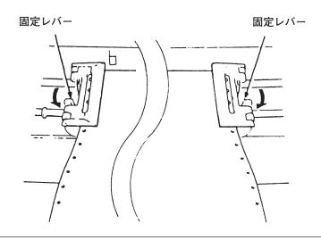
(メモ) □マークの左の縦線は、第一印字文字の左端の目安です。 4 左のトラクターを最適な位置に移動し固定レバーを矢印の方向に倒してロックして ください。
