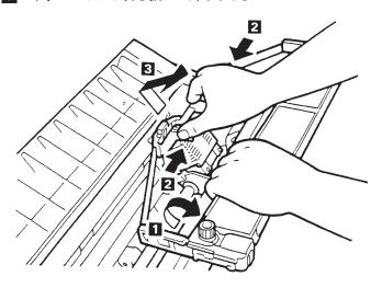
4 新しいインク・リボン・カートリッジを紙箱から取り出し、2-5ページの2.1.4、『イ ンク・リボン・カートリッジのセット』の項を参照して取り付けてください。
