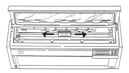
5 左右のトラクターの用紙押さえを開き、用紙をトラクターから外してください。
