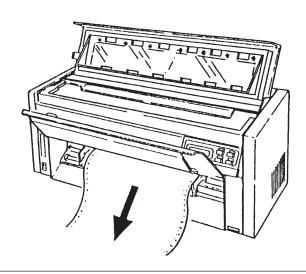
8 連続用紙をプリンター後方から静かに引き、用紙をすべて取り除いてください。イ ンク・リボンのために用紙が取りにくい場合は、インク・リボン・カートリッジを 取り外してから用紙を取り除いてください。インク・リボン・カートリッジの取り 外し、取り付けは、3-64ページの3.9、『インク・リボン・カートリッジの交換』を 参照してください。
