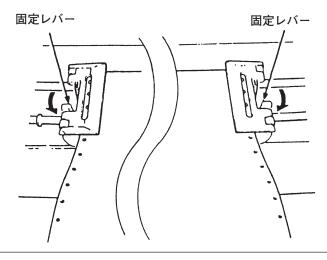
4 トラクターを手で適当な位置へ移動してから、固定レバーを倒して左右のトラクター をロックしてください。
