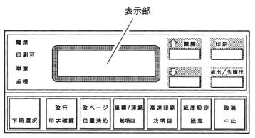
以下に操作パネル上のスイッチの基本的な取り扱いを説明します。
