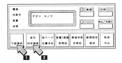
2 上部カバーの窓から位置確認パターンを見ながら、改行スイッチおよび分スイッチ またはよスイッチを押して、最適な位置まで用紙を送ってください。その後、「ゲダ ン キノウ」と表示されていることを確認し、印字確認スイッチを押して印字位置を 確認してください。
