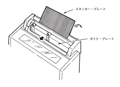
以上で、連続用紙の排出箇所のプリンター背面から上面への変更は完了しました。 操作パネル・カバーは閉じてから使用してください。
