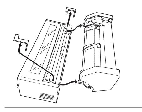
7 プリンター本体の上部カバーを開けて、印字ヘッドを左端または右端に移動し、つ まっている用紙を取り除いてください。インク・リボンのために用紙が取りにくい 場合は、インク・リボン・カートリッジを取り外してから用紙を取り除いてくださ い。インク・リボン・カートリッジの取り外し、取り付けは 3-64ページの 3.9、『イ ンク・リボン・カートリッジの交換』を参照してください。
