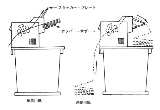
手差し給紙モード (ガイド・プレートが「手動、用紙補給」の位置にある)
