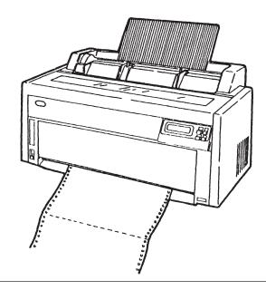
2 印刷スイッチを押し、印刷不可状態(印刷可ランプが消えている)になっているこ とを確認してから、単票/連続スイッチを押してください。単票ランプが消え、連続 紙モードになります。
