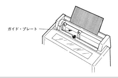
2 ロック・レバーを解除して、用紙ガイドを用紙に合わせるように移動してください。
