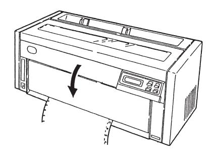
以上で印刷中の左右方向の微調整は終了です。 操作パネル・カバーを閉じて使用してください。
