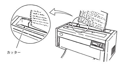
3 操作パネル・カバーを開け、下段選択スイッチを押し、「ゲダン キノウ」と表示され ていることを確認してから、位置決めスイッチを押してください。ブザーが鳴り、ミ シン目位置が記憶されます。
