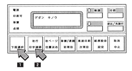
3 上部カバーの窓から位置確認パターンを見ながら介スイッチまたは小スイッチを押 して最適な位置まで用紙を送ってください。その後、「ゲダン キノウ | と表示されて いることを確認し、印字確認スイッチを押して位置確認パターンを印刷してくださ 11
