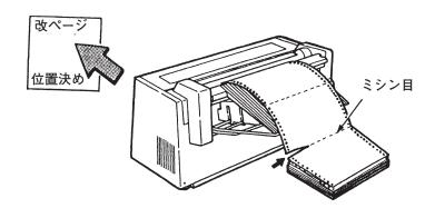
3 連続用紙がプリンター上面より排出されている場合には、排出/先頭行スイッチを押 して用紙をプリンターの切り取り位置まで排出し、ミシン目で切ってください。
