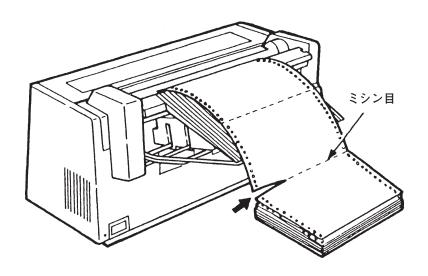
3 単票/連続スイッチを押してください。単票ランプがつき、さらに連続用紙の先端が トラクターの位置に戻ります。
