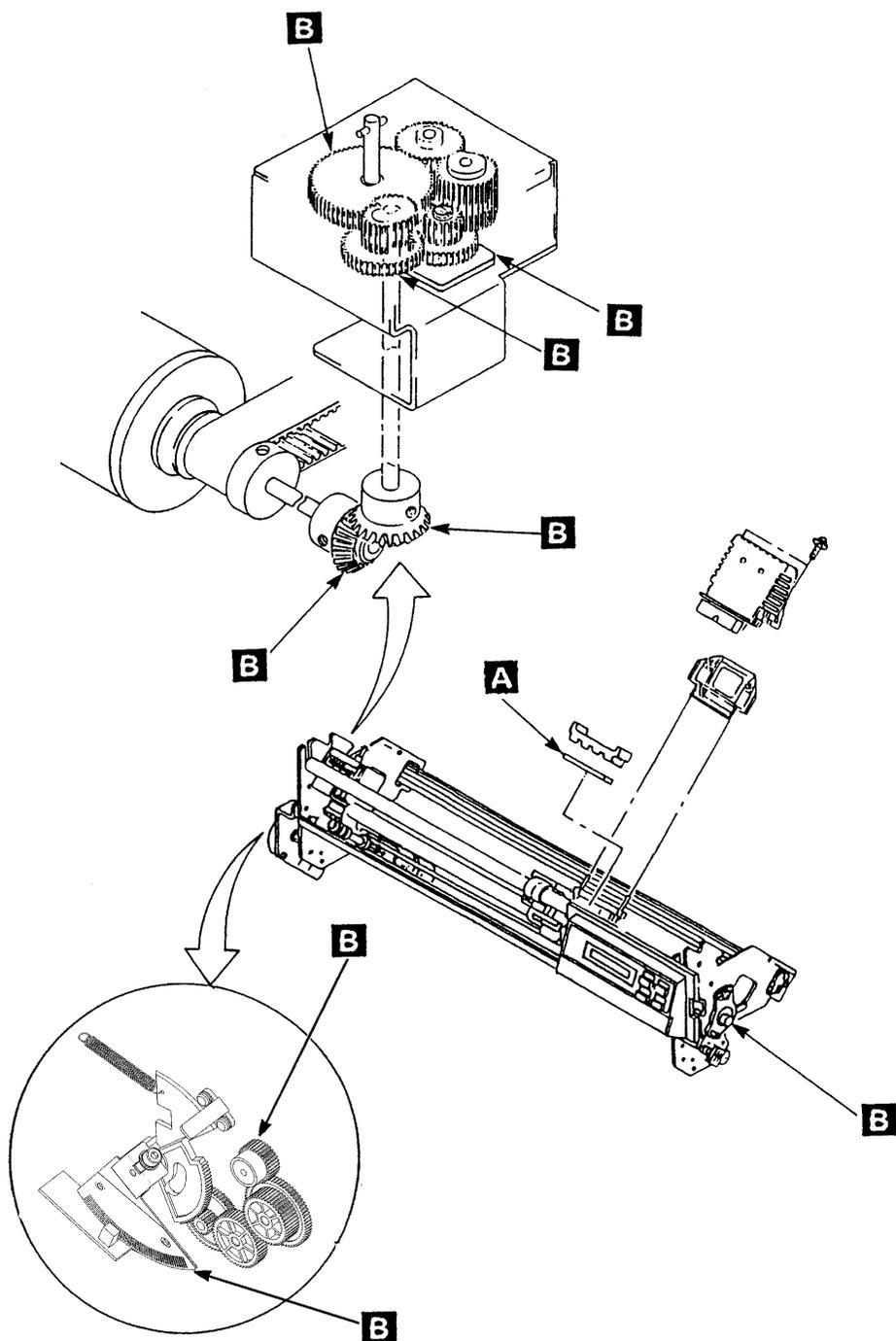
図 8-2 (2/2). IBM5579-L02 の注油個所と油の種類
