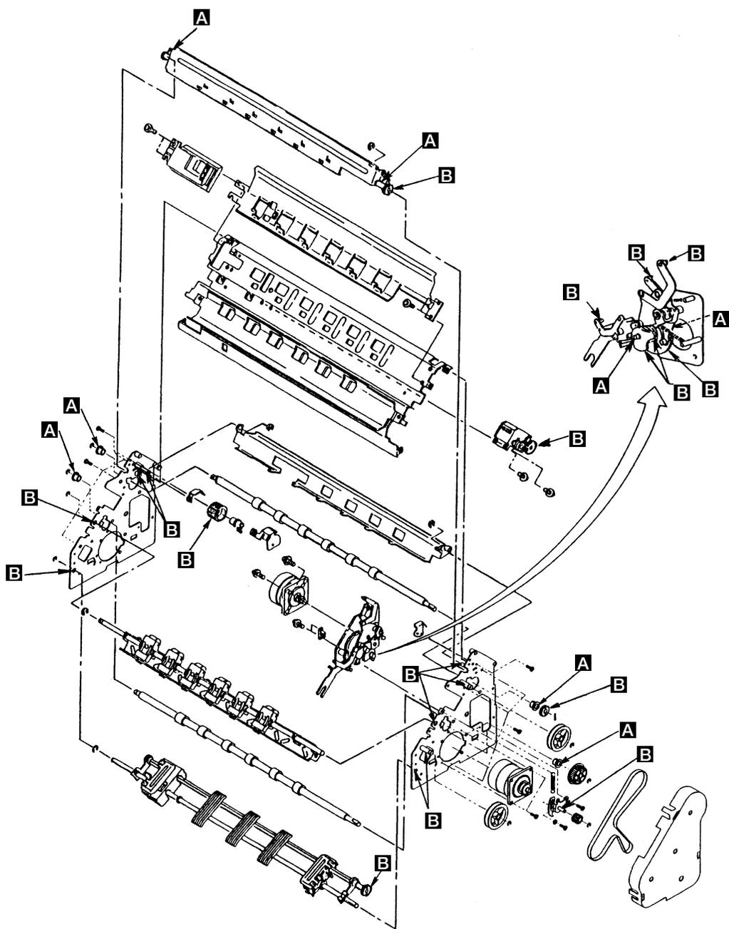
図 8-2 (1/2). IBM5579-L02 の注油個所と油の種類
