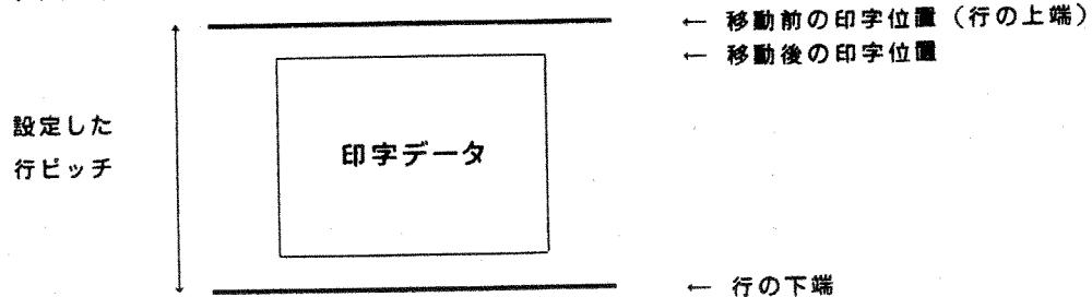
縦方向の印字位置の移動後は、同一行中で行ピッチの変更はできません。行の途中で設定された行ピッチは、次の行から有効になります。
