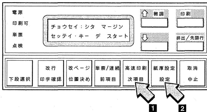
6 次項目あるいは前項目スイッチを押し、下マージンの移動量を選択してください。移動量は、-2.9 ~ +2.9mm で約 0.4mm 間隔です。「チョウセイ：シタ マージン ホセイチ +2.9 ミリ」等が表示されます。設定スイッチを押してください。調整値を記憶します。
