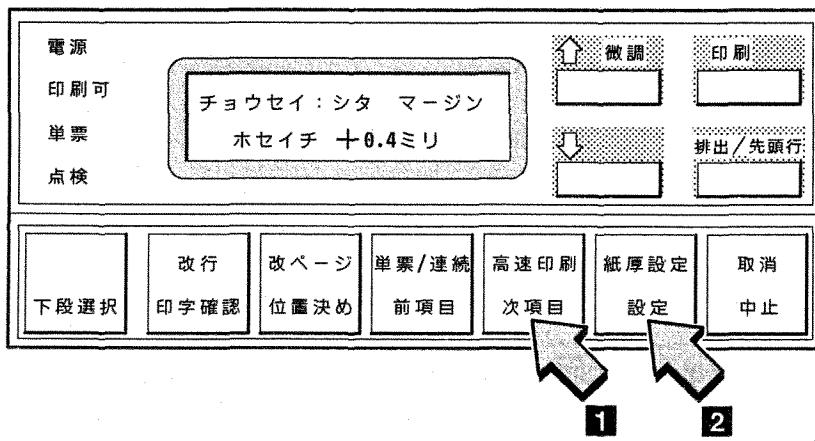
7 下マージンの現在値を確認するときは、次項目あるいは前項目スイッチを押し、「チョウセイ：チョウセイ インサツ」の表示をします。設定スイッチを押し、印刷スイッチを押してください。印刷結果が異なる場合は 6 (4-33 ページ) に戻って設定し直してください。
