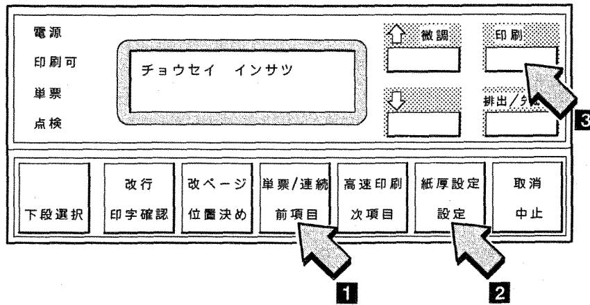
8 单票下マージン調整を終了するには、印刷スイッチを押してください。初期診断テストを実行します。
