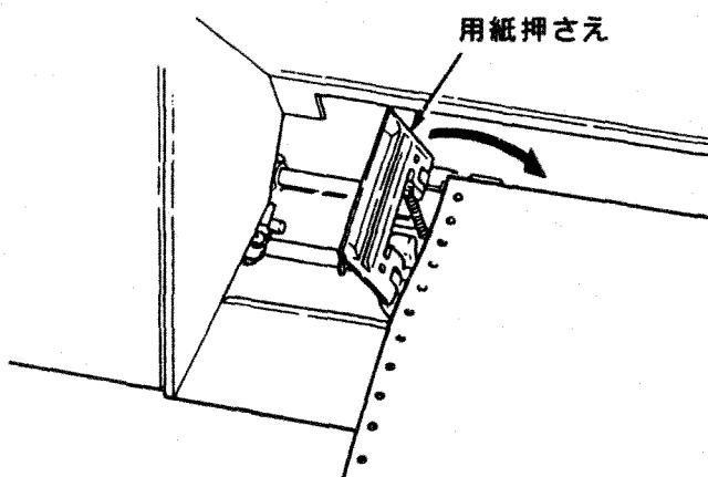
7 用紙の右端の送り穴を右のトラクターのピンにはめ、用紙押さえを閉じてください。
