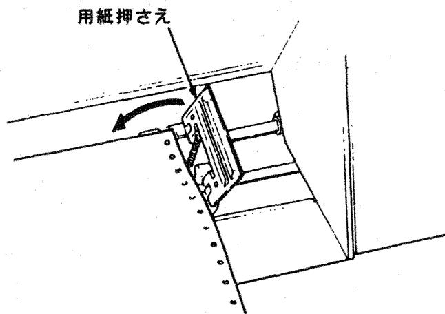
8 左のトラクターの固定レバーを矢印の方向に倒してロックしてください。
