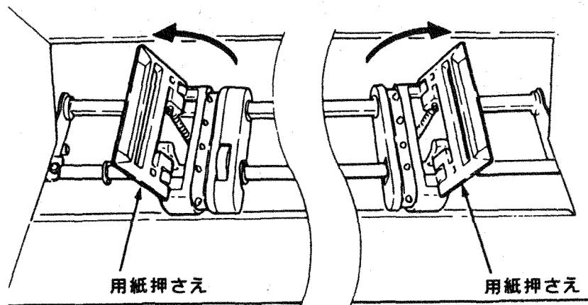
6 用紙の印刷面を上にして、図のように用紙の左端の送り穴を左のトラクターのピンにはめ、用紙押さえを閉じてください。
