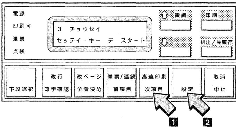
3 次項目あるいは前項目スイッチを押し、「チョウセイ：チョウセイ インサツ」を選択し、設定スイッチを押します。
