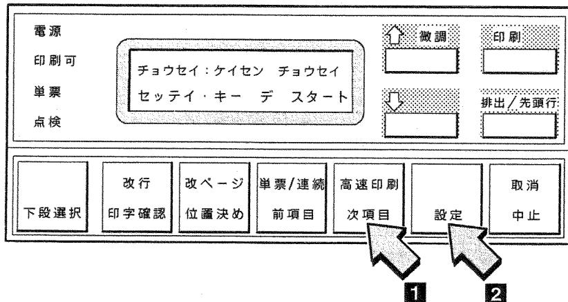
6 次項目あるいは前項目スイッチを押し、補正する印字速度を選択し設定スイッチを押してください。
