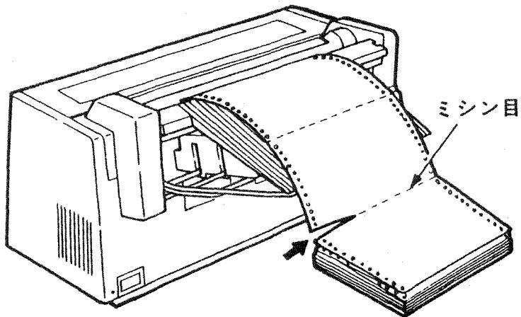
3 単票/連続スイッチを押してください。単票ランプがつき、さらに連続用紙の先端がトラクターの位置に戻ります。
