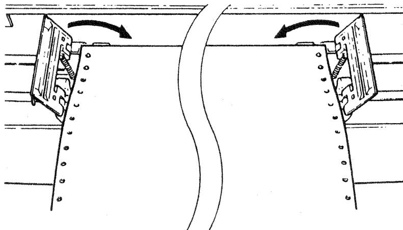
3 操作パネル・カバーを開け、単票/連続スイッチを押してください。連続用紙が先頭行位置まで送られ単票ランプが消え、連続紙モードになります。上部の用紙ガイドを連続紙の幅に合わせてください。
