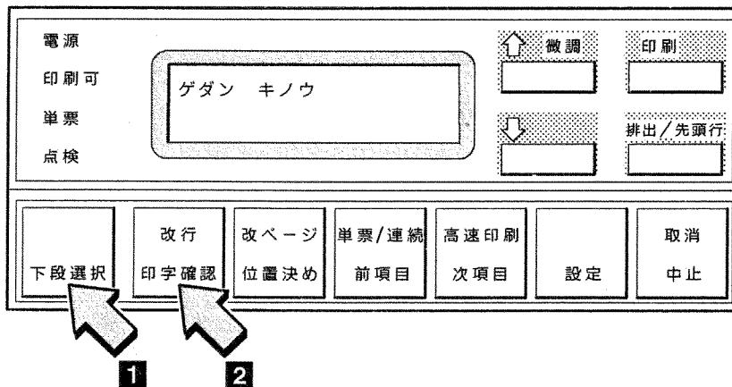
3 上部カバーの窓から位置確認パターンを見ながら $\triangle$ スイッチまたは $\square$ スイッチを押して最適な位置まで用紙を送ってください。その後、「ゲダン キノウ」と表示されていることを確認し、印字確認スイッチを押して位置確認パターンを印刷してください。
