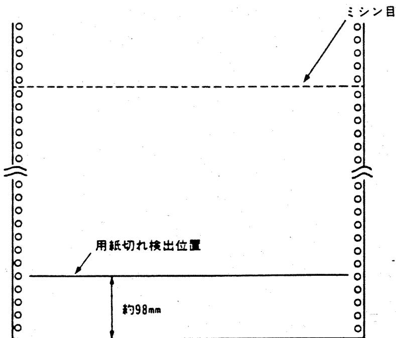
連続用紙が印刷中に用紙切れとなった場合は、印刷業務を取り消し、新しい用紙をセットしてから印刷を再開してください。そのまま最終ページの印刷を印刷可能域下端まで印刷する場合は、用紙切れ状態（点検ランプが点灯し、「001 ヨウシテンケン」が表示される）で印刷スイッチを押します。1行を印刷し再び用紙切れ状態となります。この操作を繰り返すと論理ページ長（ソフトウェアまたはプリンターの初期設定機能によって設定されたページ長）の最終行まで印刷できますが、以下の注意点を守ってください。
