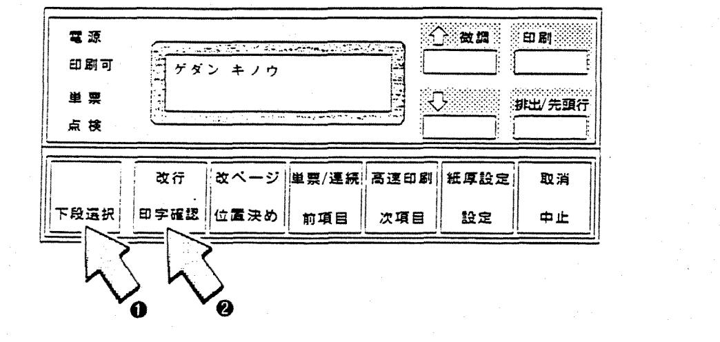
**3** 上部カバーの窓から位置確認パターンを見ながら ↓スイッチまたは ↗スイッチを押して最適な位置まで用紙を送ってください。その後、「ゲダン キノウ」と表示されていることを確認し、印字確認スイッチを押して位置確認パターンを印刷してください。
