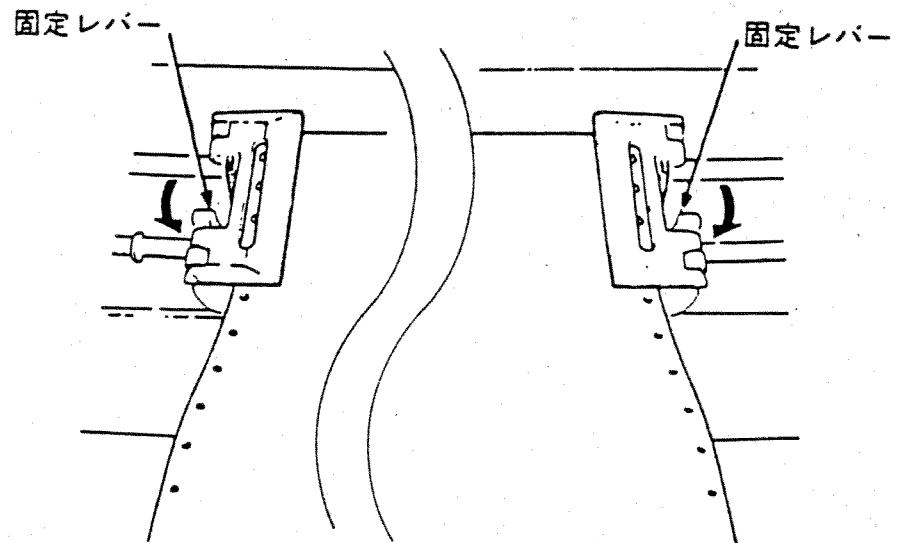
4 トラクターを手で適当な位置へ移動してから、固定レバーを倒して左右のトラクターをロックしてください。
