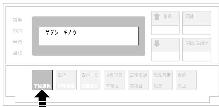
**2** 次項目スイッチを押して「1 インジ テスト」を選択し、設定スイッチを押します。
