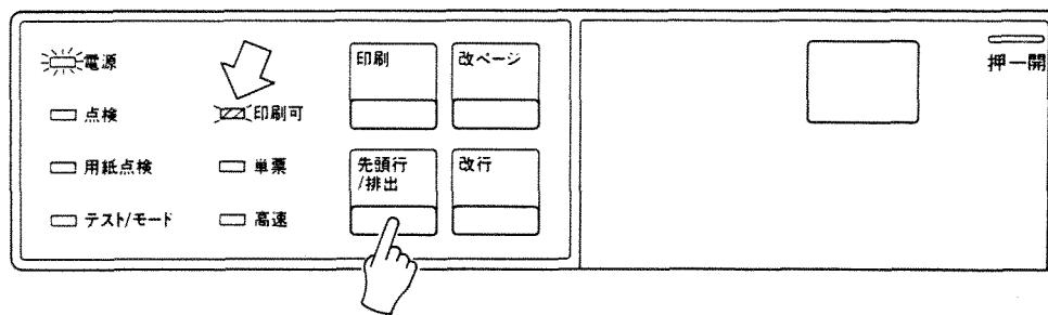
2. 用紙のミシン目と切り取り位置が合っていない場合は操作パネル・カバーを開き、↑スイッチ (Alt スイッチを押したままモード・スイッチ) または↓スイッチ (Alt スイッチを押したまま選択スイッチ) を押して、ミシン目を切り取り位置に合わせてください。
