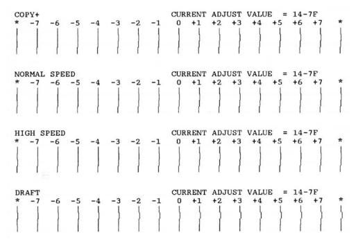
罫線テスト印刷の結果で、最もズレのない位置の数字を ▼ スイッチまたは ▲ スイッチで選択する。 **ケッテイスイッチを押す**。
