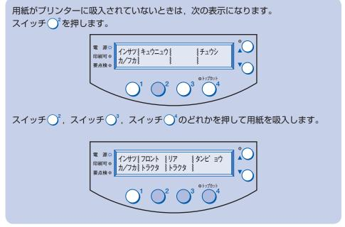
3 スイッチ ○¹を押して印刷します。
