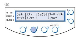
**2** スイッチ ○ T又はスイッチ ○ を押して, 72ヶ夕 又は 132ヶ夕 のどちらかの 印刷パターンを選びます。スイッチ ○ を押して確定します。
