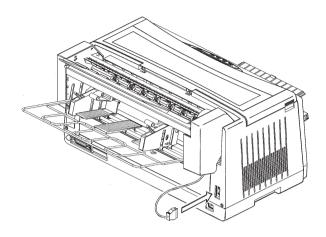
9 スタッカー・プレートを ASF の左右のカバーの内側にある穴に取り付けて ください。このときスタッカー・プレートをやや曲げて挿入してください。
