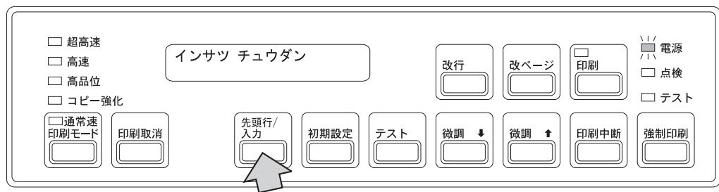
**重要:** **【先頭行/入力】**キーを2回以上押すと、印刷開始位置と用紙ミシン目が合わなくなります。また、押す回数によっては用紙がトラクターから外れて、障害の原因となります。
