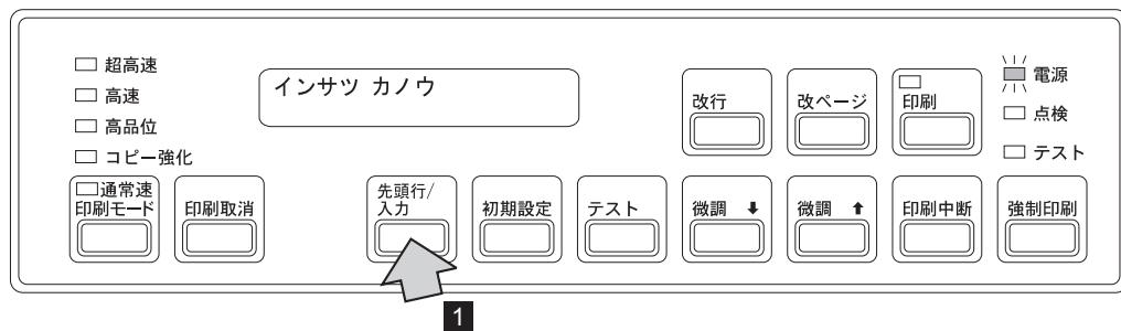
TOFインジケーターと用紙ミシン目が合った状態で [先頭行/入力] を押すと 1 用紙が一定量後退し、印刷開始位置とミシン目が一致します。
