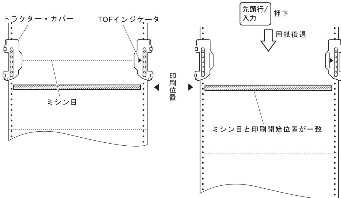
重要： [先頭行/入力] を2回以上押すと、印刷開始位置と用紙ミシン目が合わなくなります。また、用紙がトラクターから外れて障害の原因となります。
