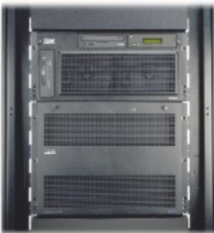
Das Modell M80 besteht aus einem 8U-Rack-Einschub mit 2, 4, 6 oder 8 64-Bit-RS64 III-Mikroprozessoren (500 MHz) mit Kupfertechnologie, von denen jeder über 4 MB L2-Cache und einen 5U-E/A-Einschub mit 14 hot-plug-fähigen PCI-Adaptersteckplätzen, integriertem Fast Ethernet, Ultra SCSI und Ultra2 SCSI Controller verfügt. Jedes M80-System unterstützt bis zu vier E/A-Einschübe, wodurch eine maximale Anzahl von hot-plug-fähigen PCI-Adaptersteckplätzen von 56 erreicht wird.
