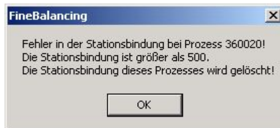
Abbildung 108: Restriktionsverletzung durch zu hohe Stationsbindung
