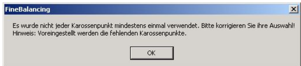
Abbildung 107: Restriktionsverletzung beim Erzeugen der Austaktung
